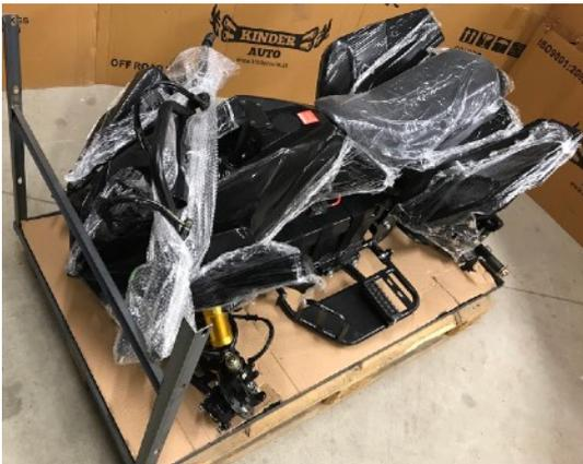
Nachdem du den Karton entfernt hast, siehst du das Quad befestigt an einem Metallrahmen. Nimm dir einen 14mm Gabelschlüssel oder Ratsche mit 14-er Nuss und öffne alle Schrauben am Metallrahmen um diesen entfernen zu können. Der Unterteil und Vorderteil vom Metallrahmen bleibt noch da. Sieht dann so aus wie im Bild links. Nimm auch gleich mal die Reifen und Kleinteile und Kartons weg und lege diese zur Seite.
