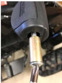
Am Lenker wird jetzt noch der Handschutz befestigt. Dreh dazu die Schraube aus der Stirnseite des Lenkers raus, samt der messingfarbenen Abstandshülse. Bereite den Handschutz zur Montage vor wie am Foto zu sehen, also auf der einen Seite schon den Haltebügel anschrauben. So ist die Montage einfacher. Den Handschutz richtig positionieren und festschrauben.
