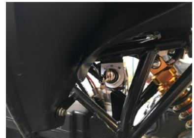
Im Differentialgetriebe befindet sich Öl. Dieses sollte etwa alle 400km gewechselt werden. Einfach die Ablassschraube an der Unterseite öffnen und das Öl ablassen. Oben bei der Einfüllschraube neues Öl rein. Benötigt werden 150ml GL-5 85W/90 Getriebeöl.
